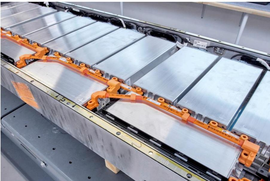
© MAN, Offene Batterie von MAN, in denen die einzelnen Batteriemodule zu sehen sind
